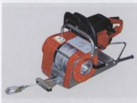
In alto, aggancio del verricello motorizzato all'albero. La corda va mantenuta in tensione manualmente.
